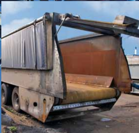
Entladeband für 40 Tonnen Steinkohle. Erst Siegling Transtex macht diese kompakte Anlagenkonstruktion möglich.
